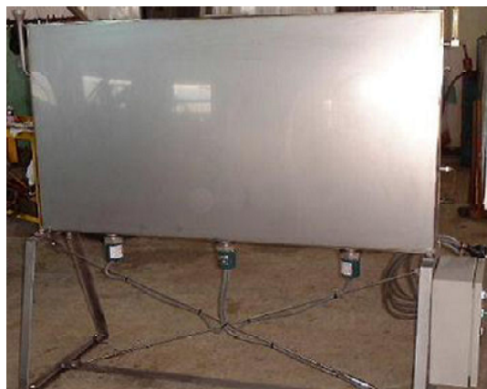
b) ステンレス製・乾燥機 水用プラグヒーター三相 200V、 温度調節付き (850 × 1550mm)
