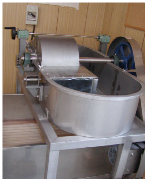
d) 漉き紙・圧搾機 各種の漉き紙を圧搾するために使用される。
