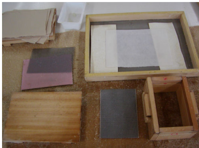
1) 「はがき」手漉き作業に使う用具、机上での基本設定
