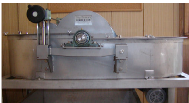
c) ステンレス製ホルンダー型ピーター 多様な原材料への適用を考慮して、ホルンダー型の叩解機を採用した(上：側面、右：内部)
