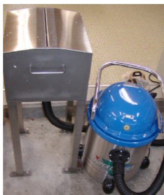
d) 漉き紙・圧搾機 各種の漉き紙を圧搾するために使用される。
